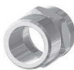
AI3/8 013 03 12 20 03 Adapterstück für Fremddüsen mit Außengewinde, IG 2-GE auf IG 3/8" adaptor piece for external nozzles with male thread, female 2-GE to female 3/8"
